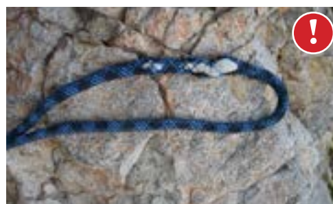
Nevarno obrabljena vrv.
