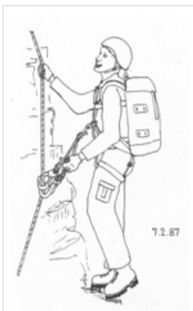
Pritrditev na pokončno vravno ograjo s samovarovalnim kompletom. (Avtor: Branko Ivanek)
