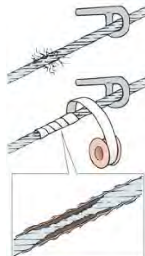
Slika 24: Povijanje jeklenice s trakom daljno-ročno pripelje do njene notranje korozije.
