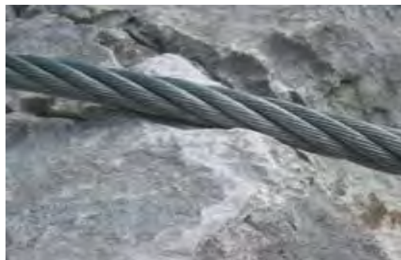
Slika 50: jeklenica se drgne ob skalo in se kmalu poškoduje.
