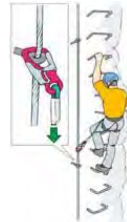
Slika 10: Vponka na očesnih sidrih z močno prednapeto jeklenico
