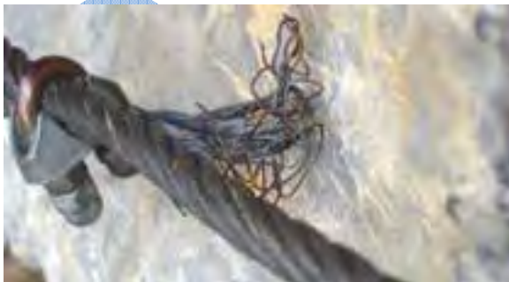
Slika 45: razcefrana jeklenica predstavlja nevarnost poškodb za plezalca
