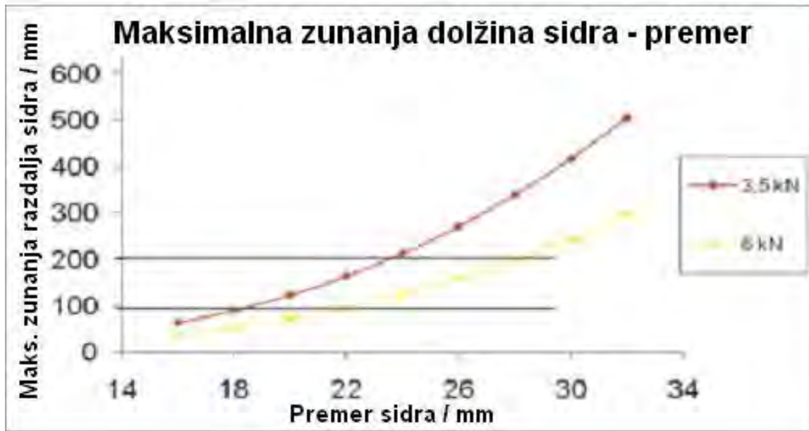
Slika 15: Razmerje med zunanjo dolžino in premerom
