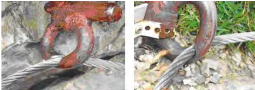
Slika 19: odbrušena očesa sider
